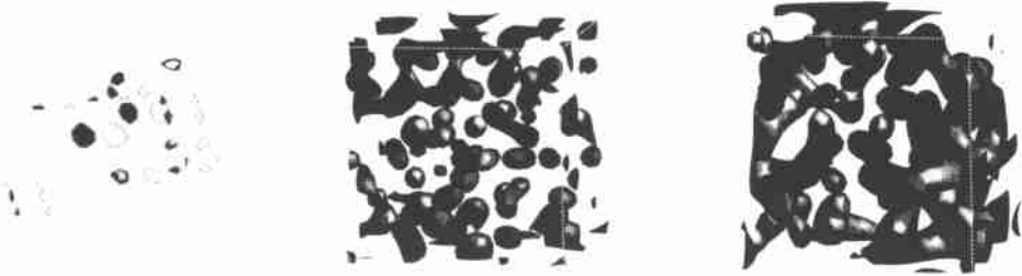
图 3 不同动力学模拟步数后溶液体系中 PO 在 H_0 = 0.50 时的等密度面 (从左到右分别对应模拟 100 步、500 步、1000 步后体系的介观形貌)
